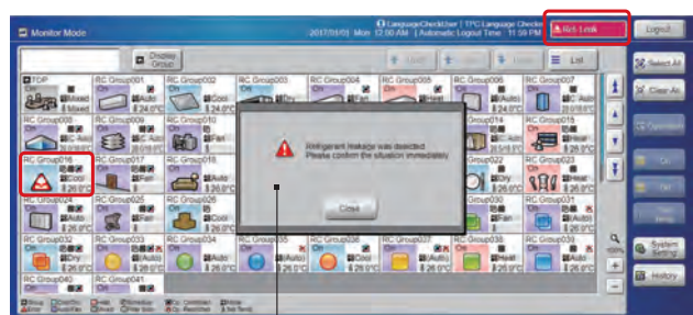
Wyskakujące okienko z informacją o wycieku
